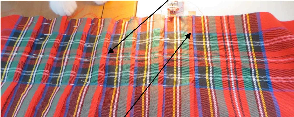
Cousez vos plis à 1 mm du bord du pli (piqûre nervure) sur 10-15 cm et n'oubliez pas d'enlever au fur et à mesure vos épingles pour ne pas casser votre aiguille machine.
