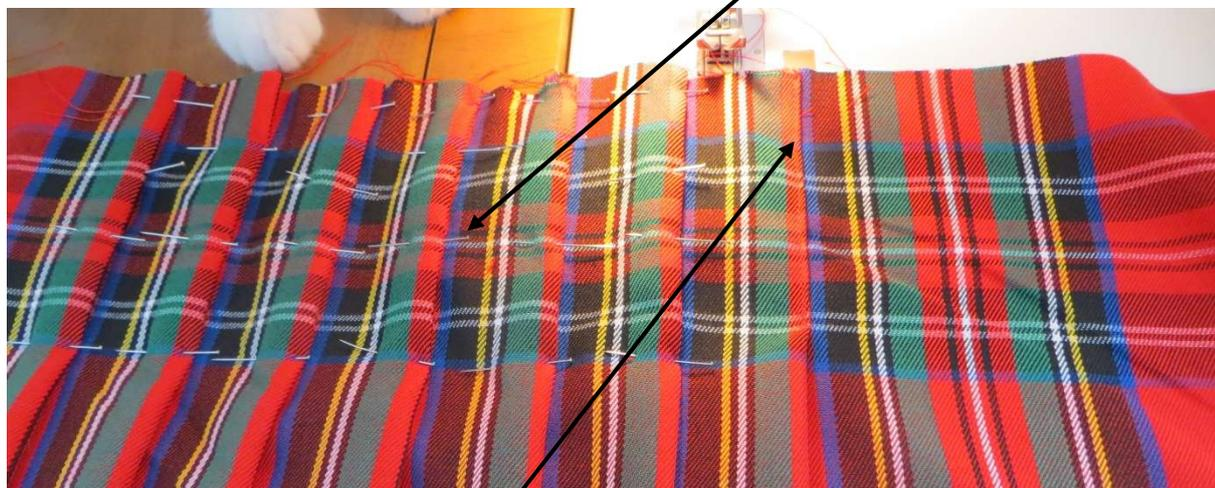
Cousez vos plis à 1 mm du bord du pli (piqûre nervure) sur 10-15 cm (N'oubliez pas d'enlever au fur et à mesure vos épingles pour ne pas casser votre aiguille machine.)
